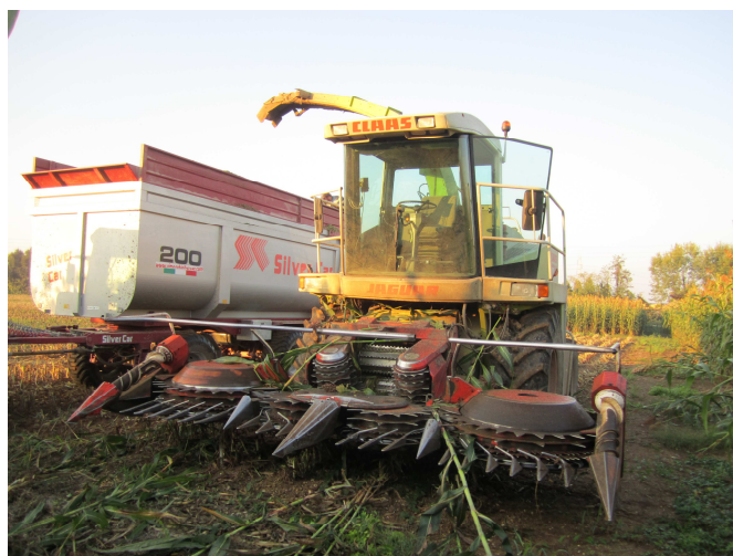
Figura 7: Máquina segadora-trituradora-cargadora (fuente: CETA)
